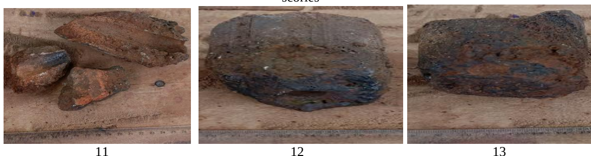
Fig. 11: Fragments de tuyères ; Fig. 12: Nez de tuyères très scorifiés ; Fig. 13: Nez de tuyère bouché par les scories
