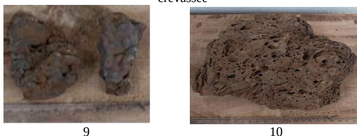
Fig. 9: Scories coulées internes de petite taille ; Fig. 10: Scories coulées internes de coulures irrégulière crevassée
